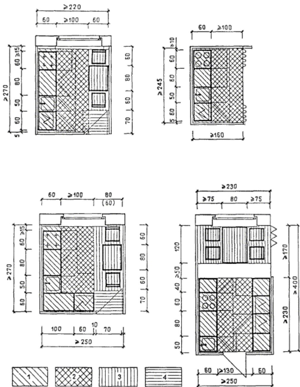
Рис. 55. Схема рациональной привязки оборудования в кухнях разного размера
