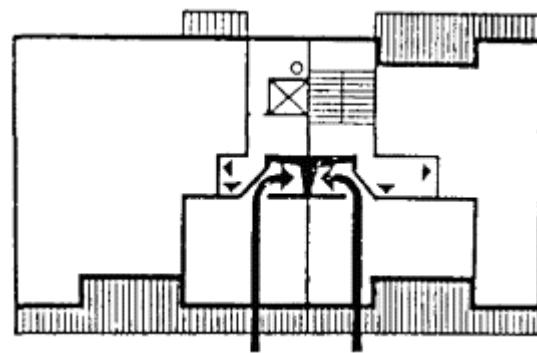
Рис. 64. Схема устройства шахтного проветривания в четырехквартирной секции
