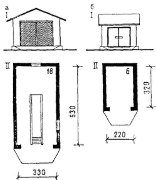
Рис. 33. Гаражи для автомашины (а) и мотоцикла (б)
