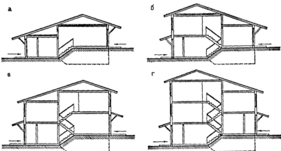
Рис. 2. Схемы домов с квартирами, имеющими перепад в 1/2 этажа
