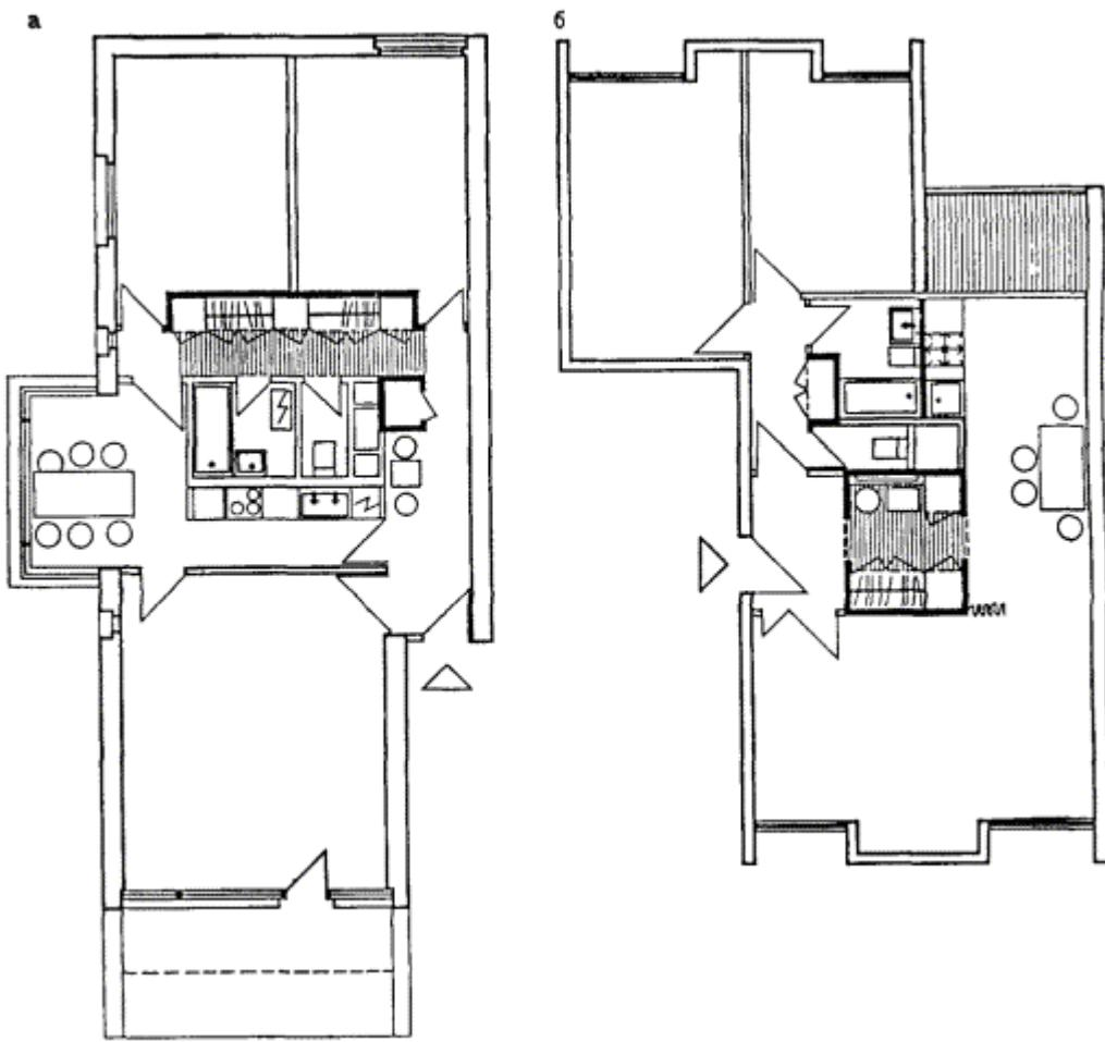
Рис. 44. Устройство проходной гардеробной (зарубежный опыт)
