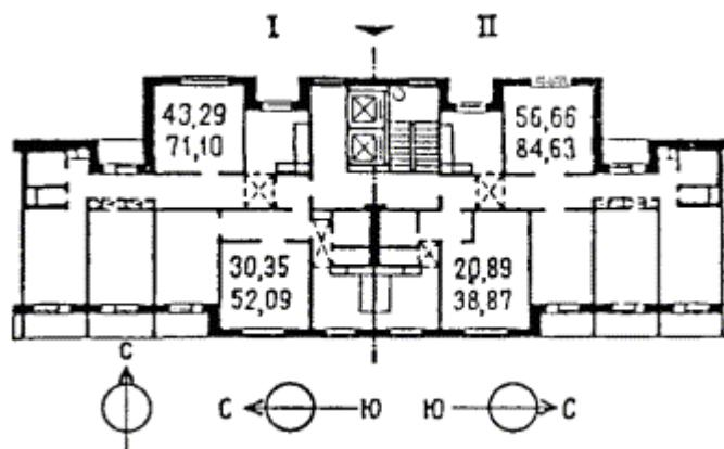
Рис. 20. Шумозащенная блок-секция четырехквартирная для размещения на меридиональных и южной сторонах широтных магистралей
