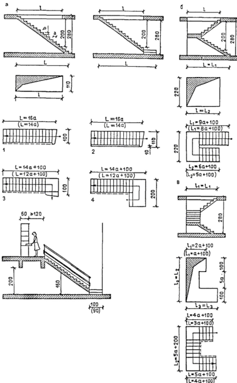
Рис. 28. Типы и габариты внутриквартирных лестниц
