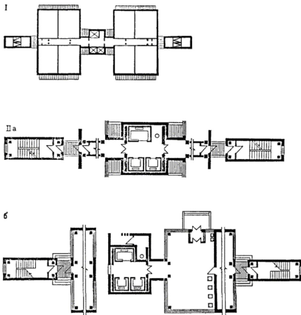
Рис. 13. Здания с незадымляемыми лестничными клетками, вынесенными в отдельные объемы
