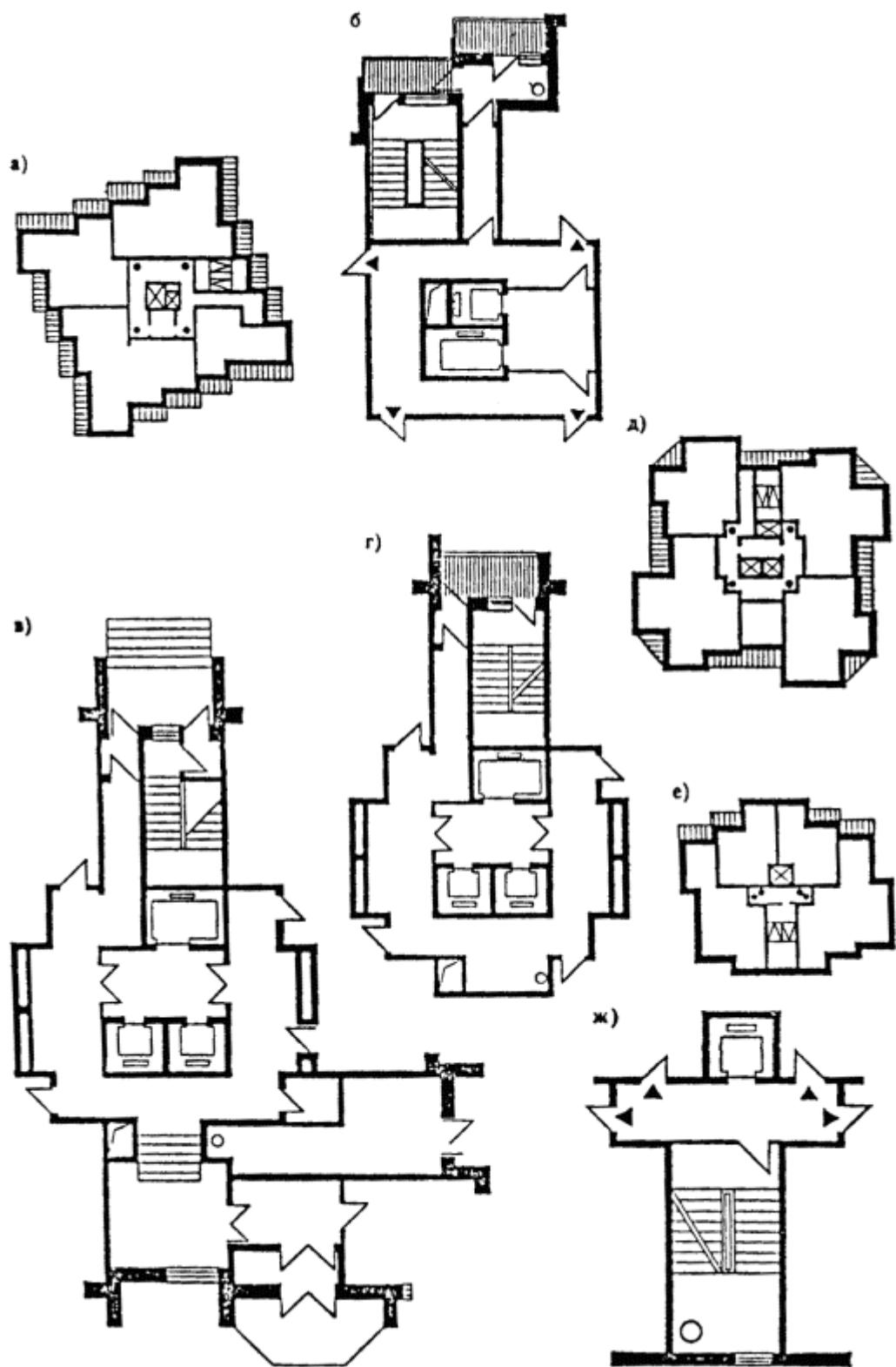
Рис. 11. Схемы узлов вертикальных коммуникаций в различных планировочных решениях дома
