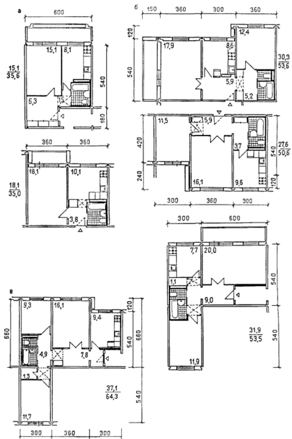
Рис. 38. Однокомнатные (*α*), двухкомнатные (*β*) и трехкомнатные (*γ*) квартиры в крупнопанельных жилых домах с узким и смешанным шагами поперечных несущих стен (примеры различной планировки)
