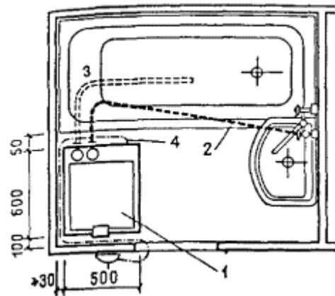
Рис. 62. Схема размещения автоматической стиральной машины максимальных размеров, подключаемой к инженерному оборудованию
