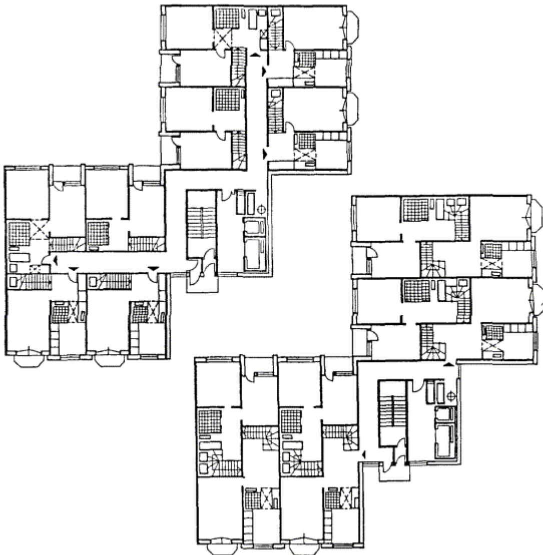
Рис. 22. Рядовая (а) и угловые (б) шумозащищенные блок-секции с квартирами в двух уровнях
