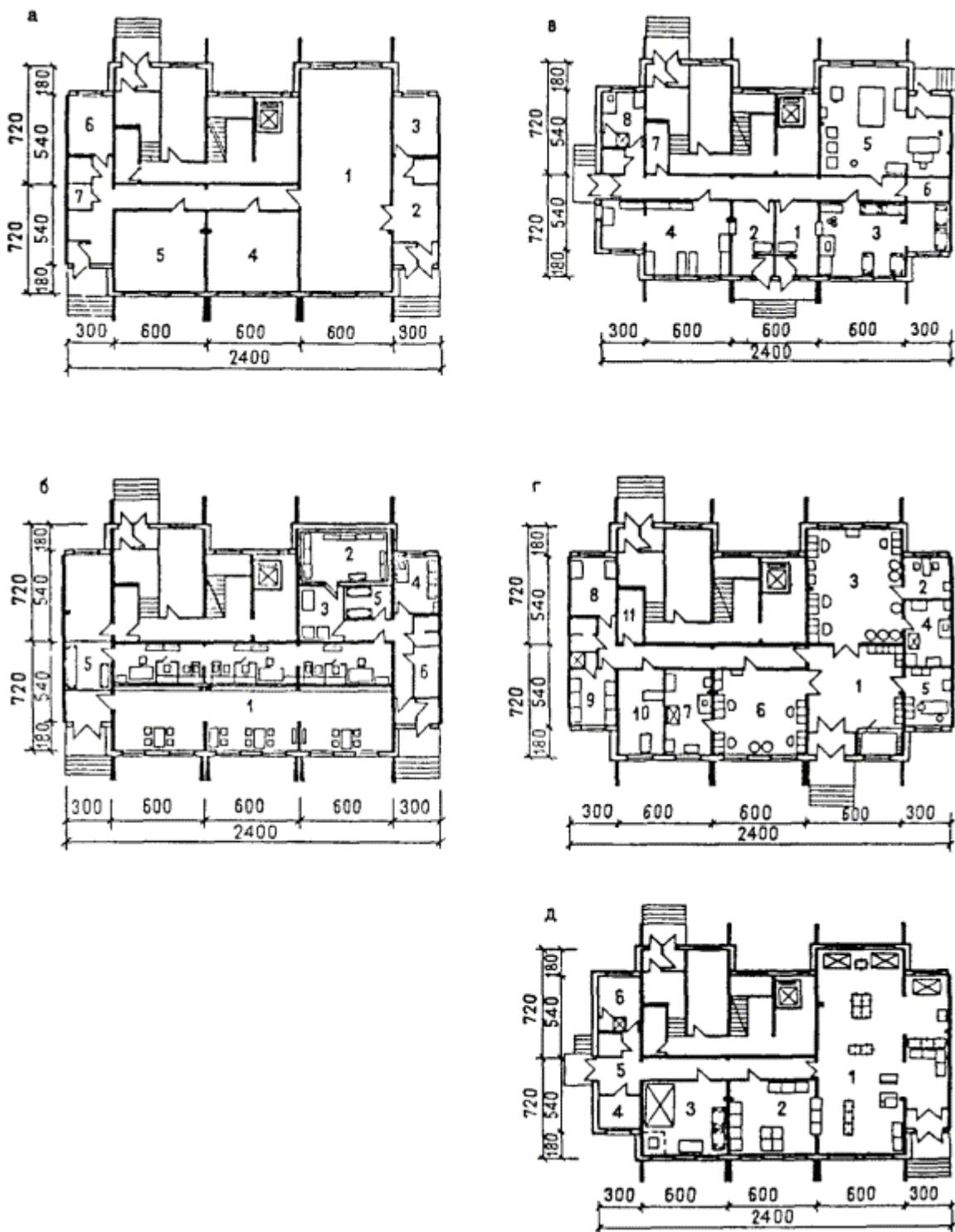
Рис. 24. Устройство различных встроенных помещений общественного обслуживания (на примере блок-секции системы ГСПД)
