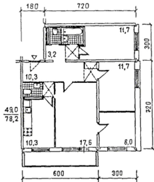
Рис. 39. Четырехкомнатная квартира с проходной общей комнатой в одну из спален
