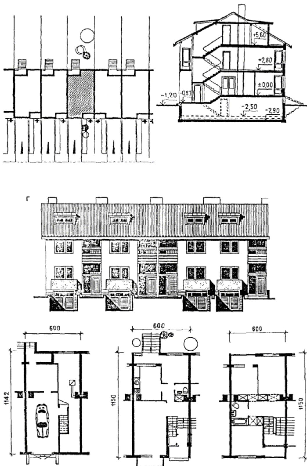
Рис. 32. Примеры устройства гаража в подвальном и первом этажах одно- двухэтажных домов
