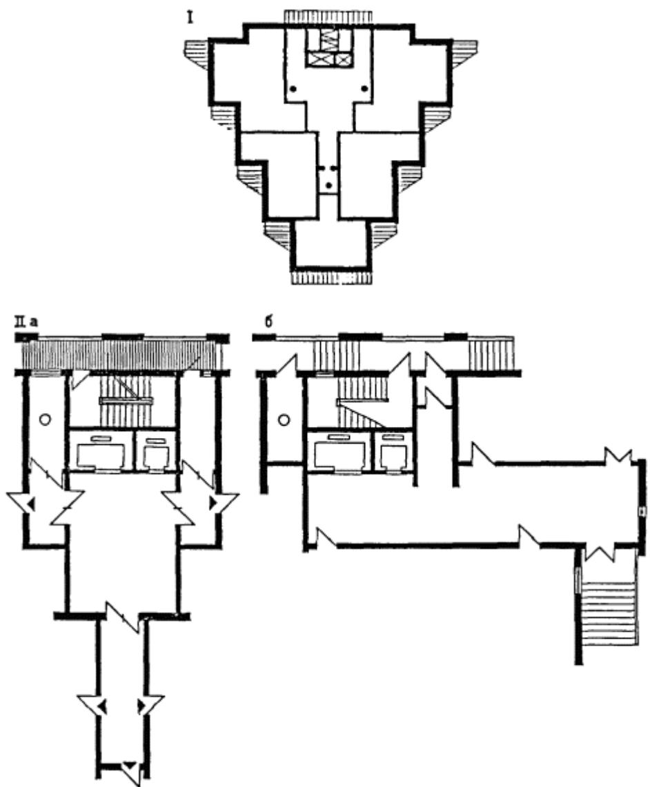
Рис. 10. Здания с направленной формой плана.
