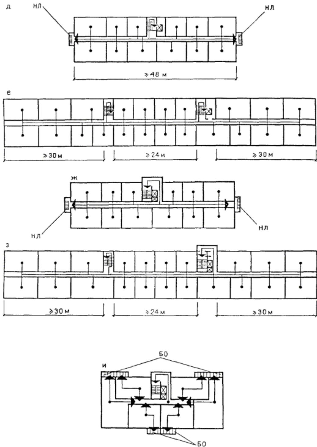
Рис. 31. Противопожарные требования к путям эвакуации (с. 32 - 34)
