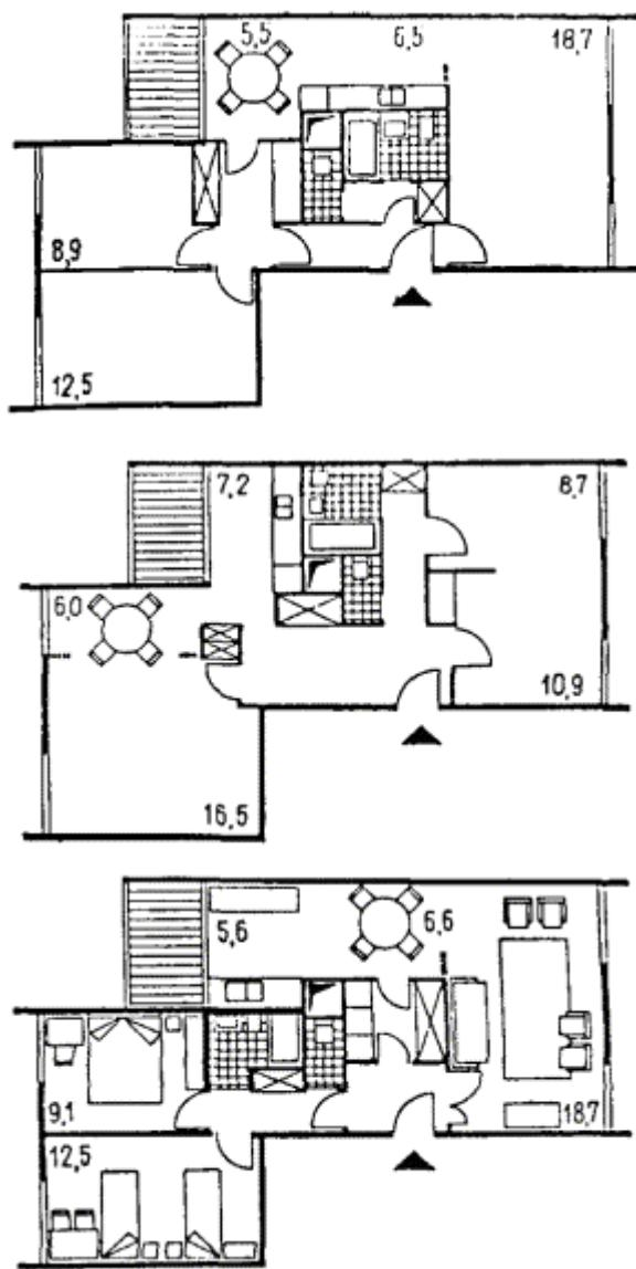
Рис. 43. Варианты планировочной организации квартиры в одинаковых габаритах
