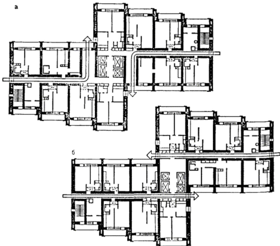
Рис. 66. Схемы углового (*а*) и сквозного (*б*) проветривания одно- и двухкомнатных квартир в коридорных домах
