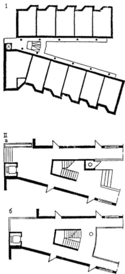
Рис. 15. Здание с галерейной планировочной схемой
