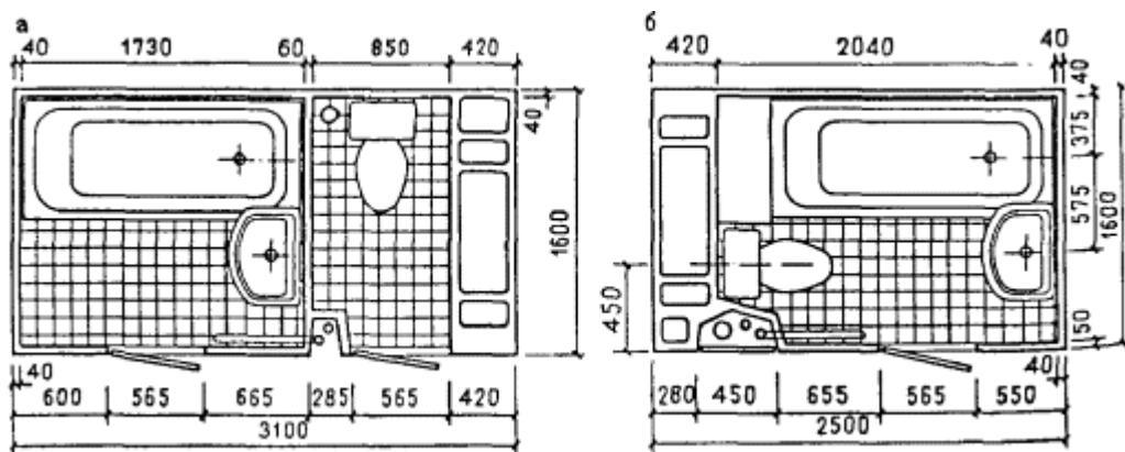
Рис. 61. Перспектива решения объемных санитарно-технических кабин, совмещенных с вентиляционным блоком
