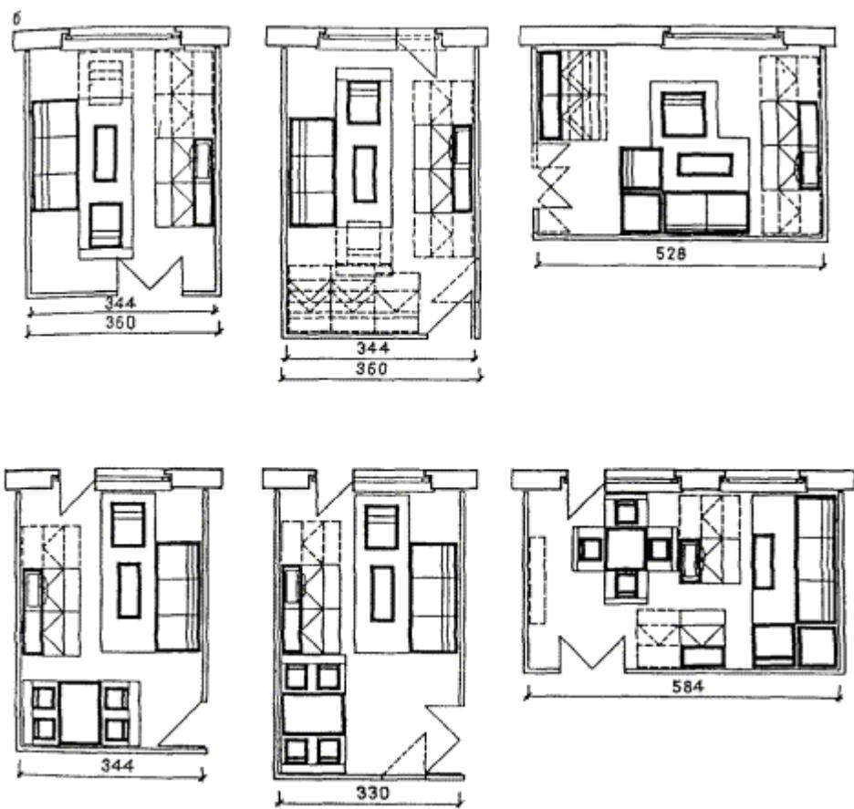
Рис. 47. Меблировка общей комнаты в двухкомнатных (а) и трехкомнатных (б) квартирах
