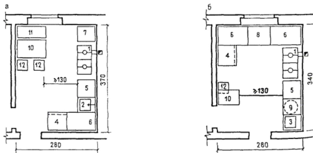
Рис. 59. Кухня сельского жилого дома с плитой на твердом топливе, водоснабжением и канализацией (а) и без водоснабжения и канализации (б)
