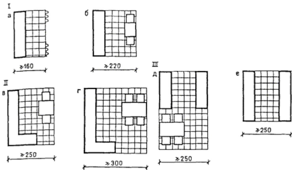
Рис. 54. Устройство функциональных зон в кухнях с размещением зоны приготовления пищи
