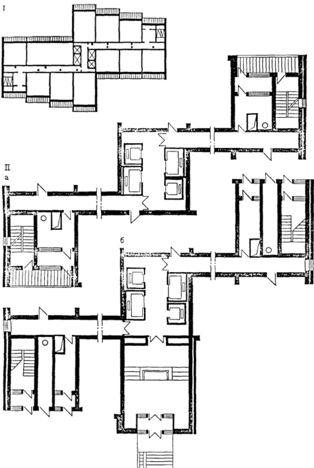
Рис. 12. Здания с рассредоточенными вертикальными коммуникациями
