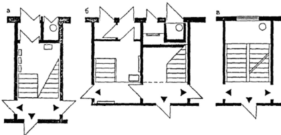
Рис. 5. Размещение мусоропровода в лестничной клетке при различной организации входа в здание
