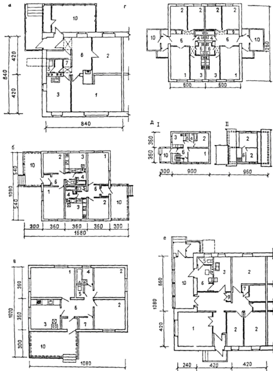
Рис. 42. Типы квартир в одноквартирных и блокированных домах в сельских населенных пунктах
