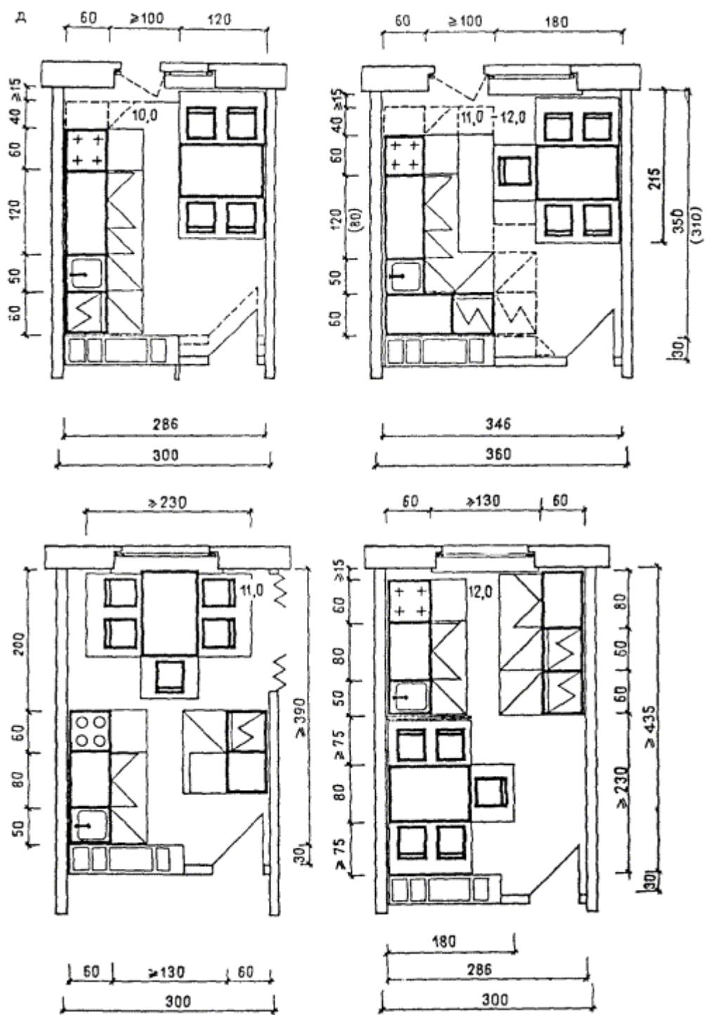
Рис. 56. Схемы размещения мебели и оборудования в кухнях-нишах площадью 3 - 6  $\text{м}^2$  (а), кухнях площадью 5 - 6  $\text{м}^2$  (б), с вариантом размещения холодильника и вентиляционного блока (в), 8 - 9  $\text{м}^2$  (г) 10 - 12  $\text{м}^2$  (д)
