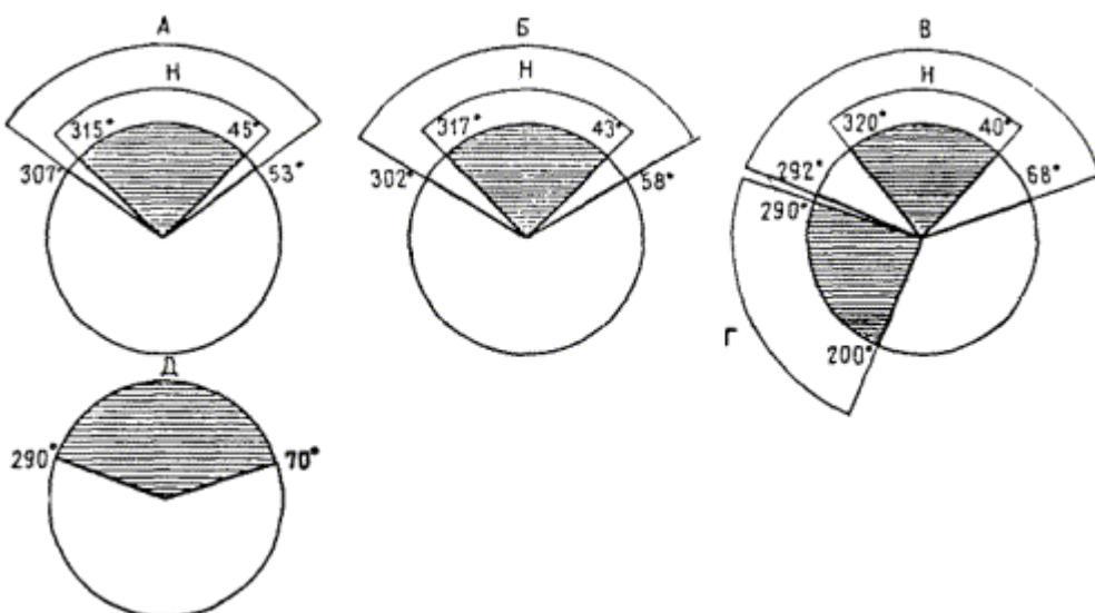
Рис. 19. Секторы неблагоприятной ориентации жилых помещений (Н) в зданиях расположенных
