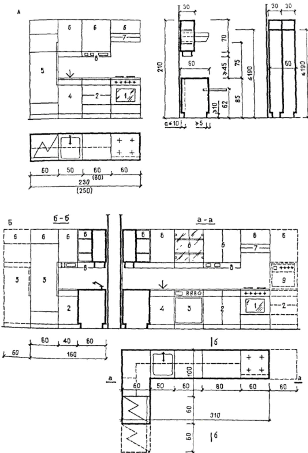
Рис. 57. Наборы стационарного кухонного оборудования
