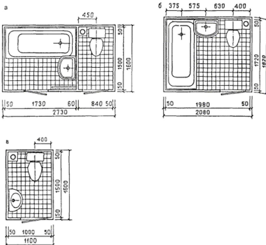
Рис. 60. Планировочные решения объемных железобетонных санитарно-технических кабин
