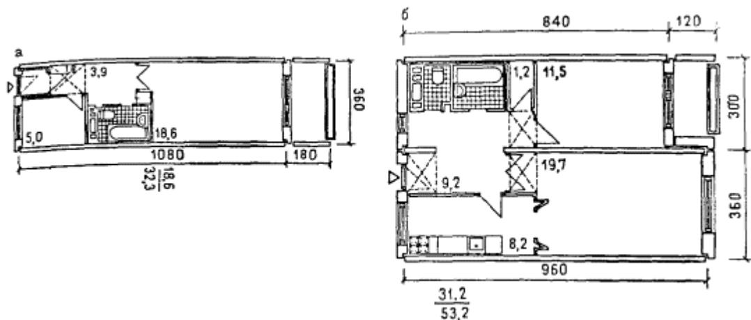
Рис. 67. Планировочные решения одно- и двухкомнатных квартир в галерейном доме
