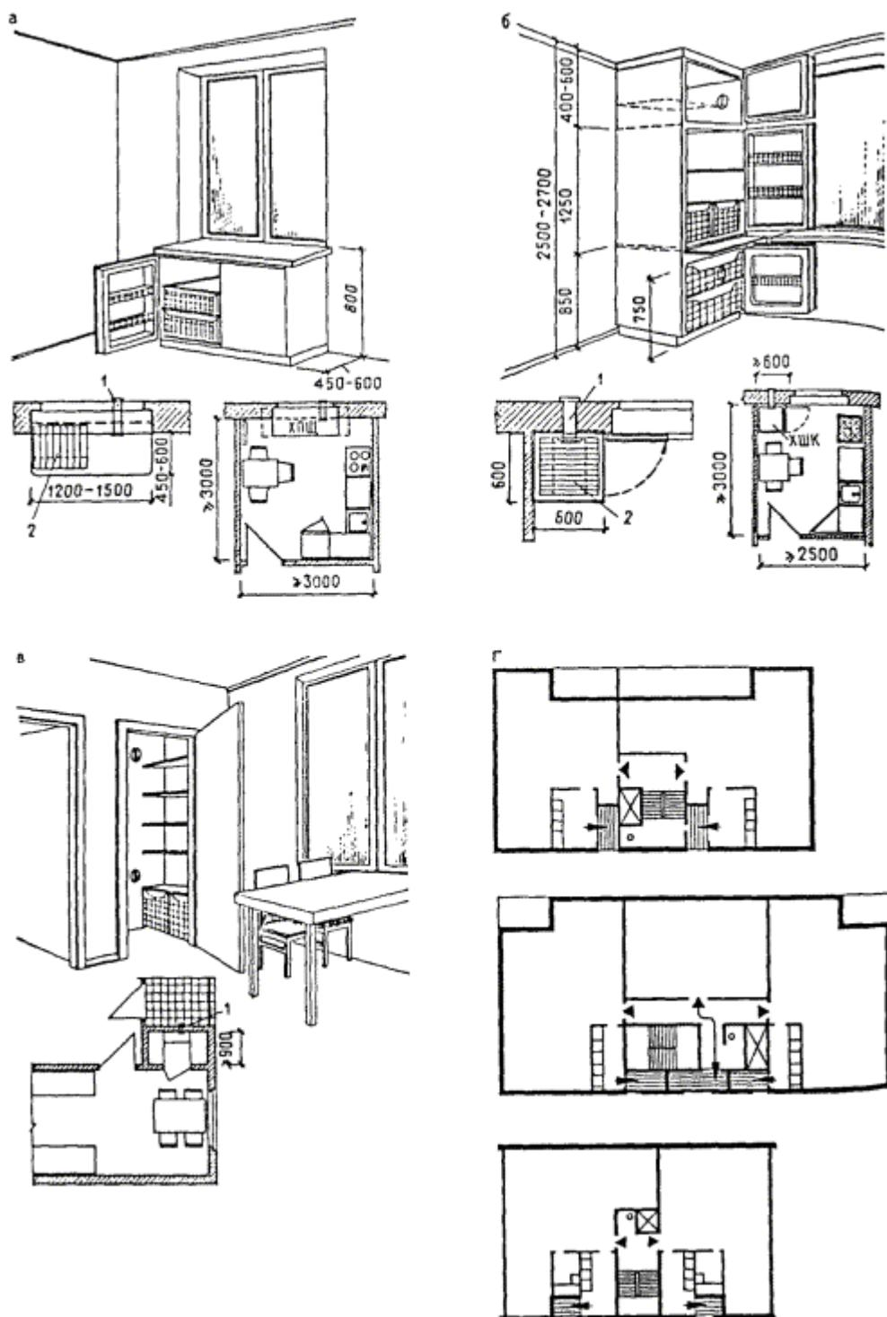
Рис. 53. Размещение холодных шкафов и кладовых для хранения продуктов
