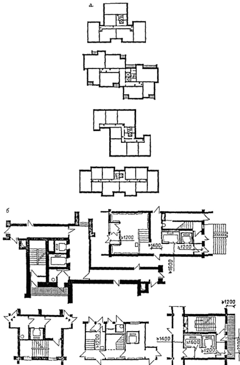
Рис. 9. Здания с компактным узлом вертикальных коммуникаций
