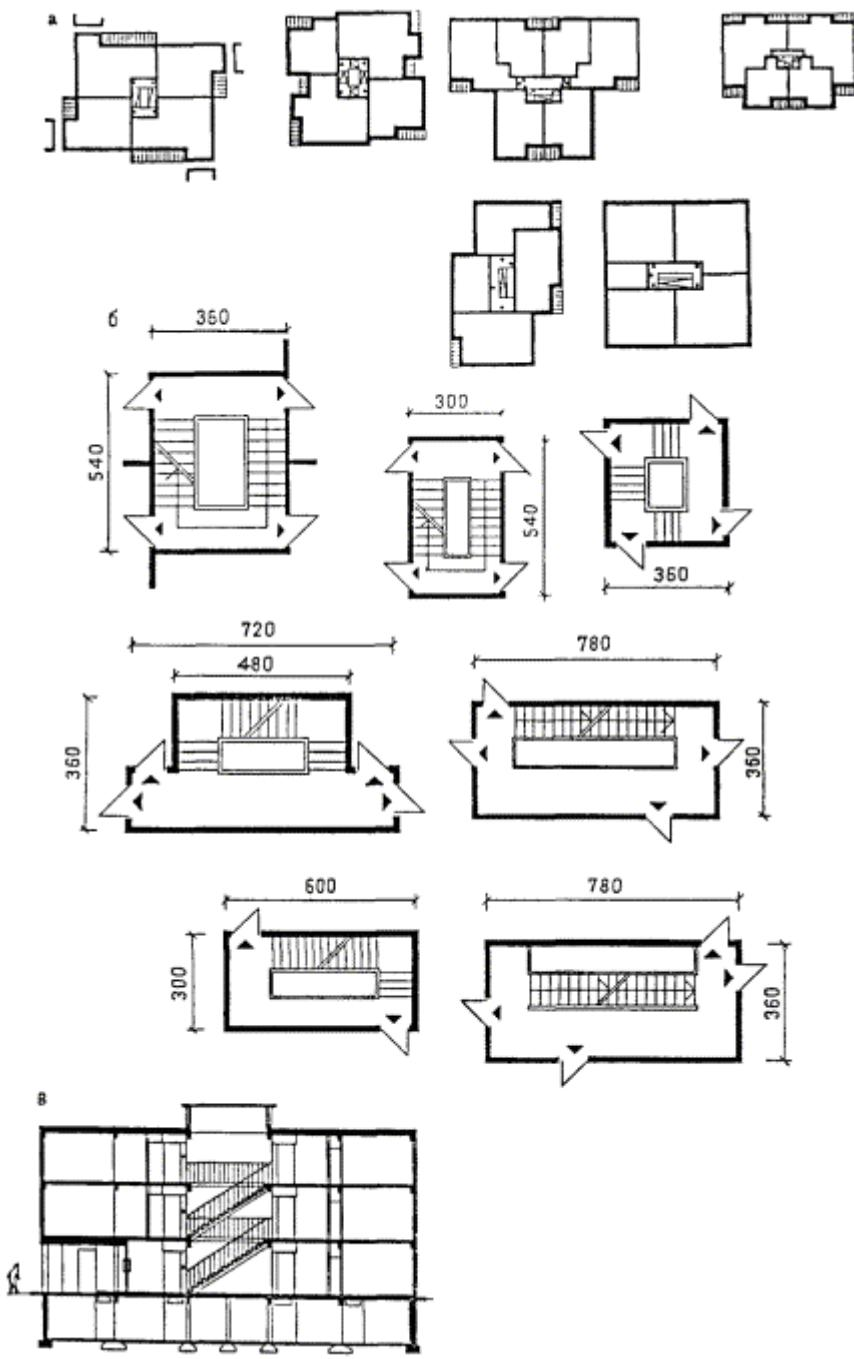
Рис. 29. Расположение лестницы в центре плана. Возможные планировочные решения
