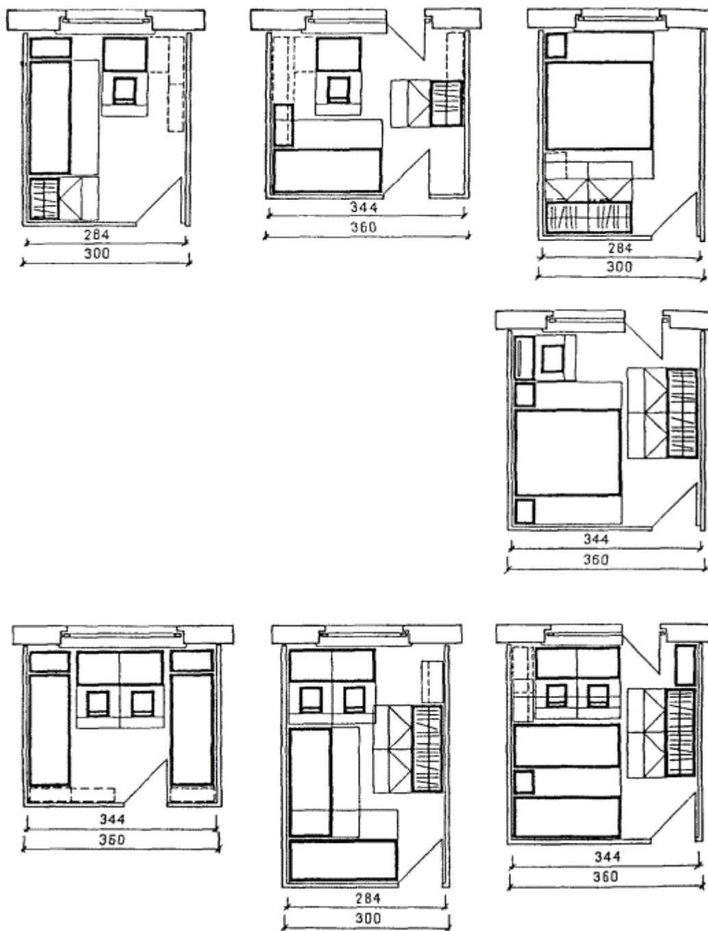
Рис. 48. Меблировка спальных комнат различных типов и размеров
