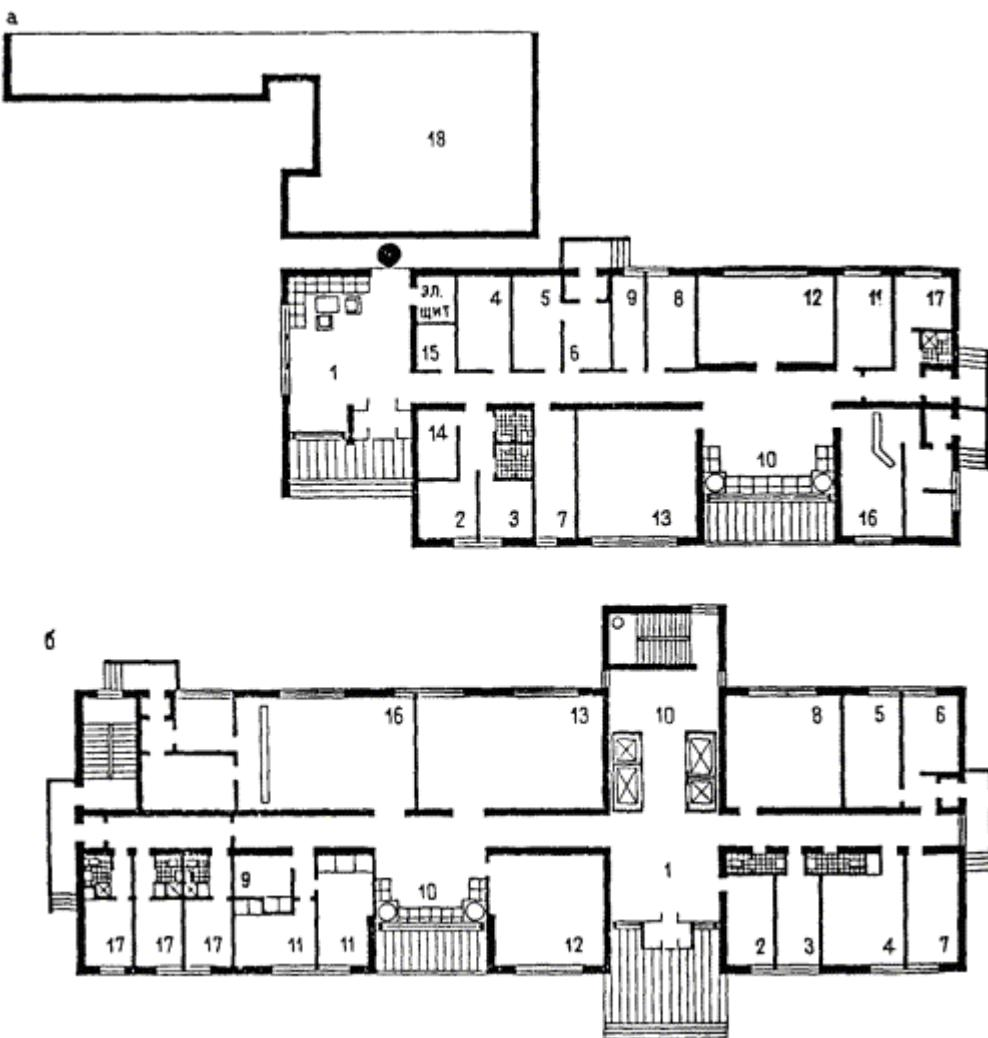
Рис. 83. Планировочные решения общественной части общежития для учащихся, размещение помещений культурно-бытового обслуживания в пристроенном объеме (а) и на первом этаже (б)
